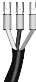
شکل ۱۷: سرکابل زدن سرسیم‌های کابل و تعیین رنگ سیم‌ها جهت اتصال
