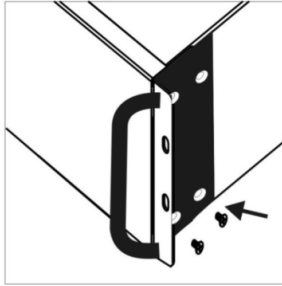
شکل ۲: نحوه‌ی اتصال قطعات L به بدنه دستگاه
